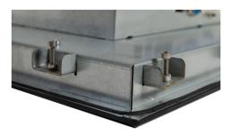
Die Geräte werden mittels beigefügter Klammern von hinten an die Schaltschranktür, das Pultgehäuse usw. verklemmt. Die in der Front eingelegte Rundschnur sorge für die Abdichtung des Gerätes zur Montageplatte. Bei Anziehen der Klemmschraube ist unbedingt darauf zu achten, dass die Spannung nicht zu hoch wird und sich Teile des Gehäuses oder die Front verbiegt.
